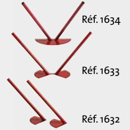
Pieds pour clastras simples Tube Ø 40 mm. Embase tôle ép. 4 mm. Piétement simple (la paire).....Réf. 1632 Piétement double droit (l'unité).....Réf. 1633 Piétement double 90° (l'unité).....Réf. 1634 Prévoir impérativement les pieds pour les clastras simples.
