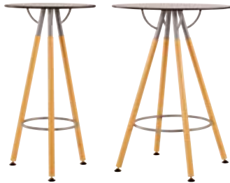
Mange-debout Structure sous plateau tôle ép. 4 mm. 4 pieds (pour le Ø 80) ou 3 pieds (pour le Ø 60) tube Ø 35 mm sur vérins, avec enjoliveurs Ø 40 mm. Repose pieds tube Ø 18 mm finition époxy. Plateau en compact ép. 13 mm. H. 1100 mm. Ø 80 cm.....Réf. 1620 Ø 60 cm.....Réf. 1621
